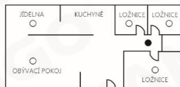
Obr. 1: Místa pro umístění detektorů kouře pro jednu obytnou jednotku s jednou částí určenou ke spaní
