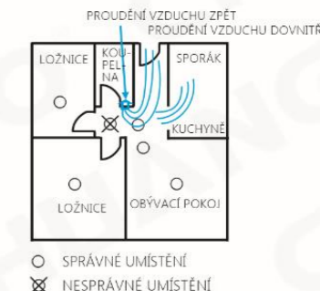
Obr. 6: doporučené umístění detektoru kouře tak, aby se zabránilo proudě vzduchu se spalinami
