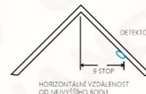
Obr. 5: doporučené umístění pro namontování detektorů kouře v místnostech s šikmých, zašpičatělým nebo sedlovým stropem
